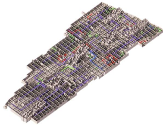
地下车库管线、桥架布置
