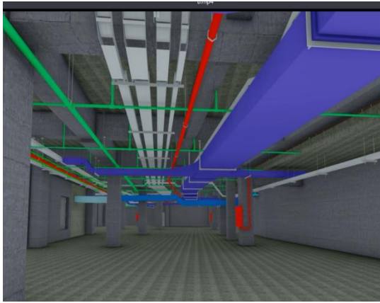
地下车库管线、桥架布置
